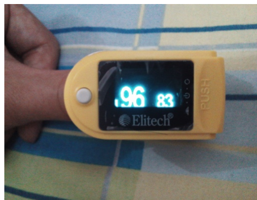
Gambar 1. Foto pulse oximeter FOX-1, Elitech untuk pemeriksaan saturasi oksigen.
